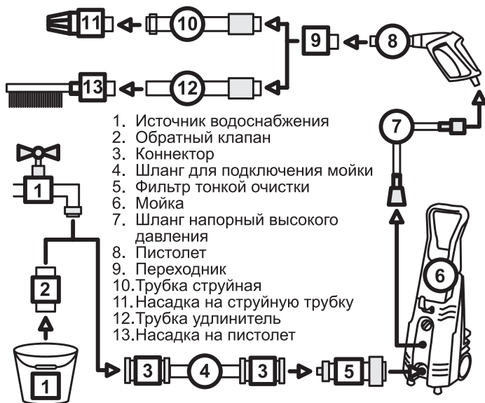
Рис. 13 Схема подключения аппарата с дополнительным оборудованием
