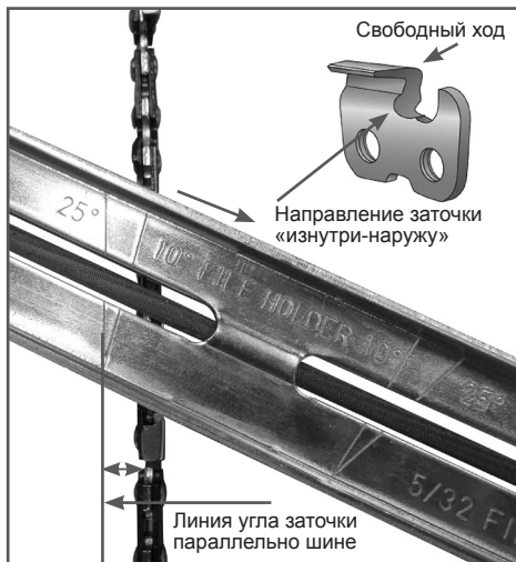
Рис.18 Определение угла заточки
