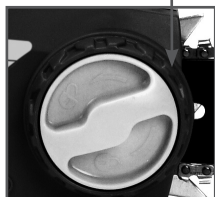
Рис. 7 Регулировка натяжения цепи
