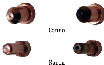
Рис. 7.6. Износ сопла и катода.
